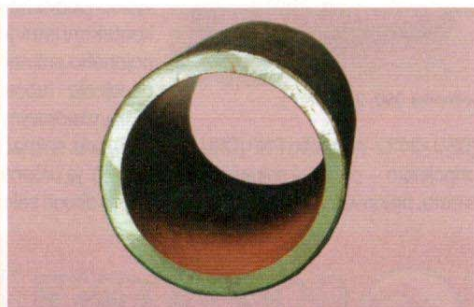
Čistenie a ochrana vnútorného povrchu vodovodného potrubia epoxidovým nástrekom – stav pred a po sanácii
